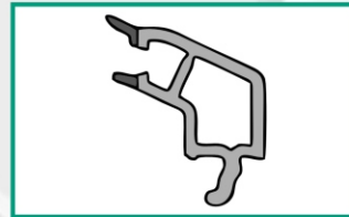
Ştapik 40mm Glass bead 40mm 0,23 kg/m Штапик 40mm
